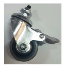
Para instalar las ruedas correctamente desenrosque tan solo la tuerca superior y extraiga una de las arandelas. La base de la estufa dispone de 4 orificios por los que podrá insertar el tornillo saliente de las ruedas. Coloque la arandela y la tuerca quitadas anteriormente por la parte superior de la base de la estufa, de forma que quede entre las dos arandelas esta última.
